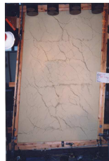
3) 木造土壁せん断耐力実験
