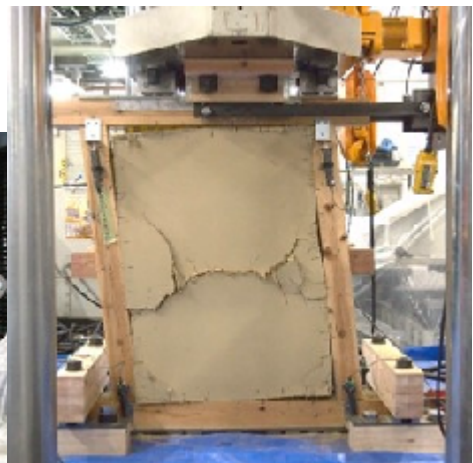
壁試験体の水平加力実験の様子
