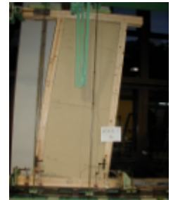
京都の土壁の水平耐力試験 (H15年度KARTH研究、試験体土塗り製作：京都左官協同組合、京都府左官技能専修学院)*
