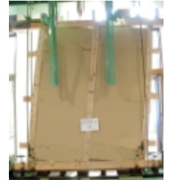
京都の土壁の水平耐力試験 (H15年度KARTH研究、試験体土塗り製作：京都左官協同組合、京都府左官技能専修学院)*
