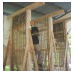
京都の土壁の水平耐力試験 (H15年度KARTH研究、試験体土塗り製作：京都左官協同組合、京都府左官技能専修学院)*
