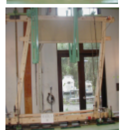
京都の土壁の水平耐力試験 (H15年度KARTH研究、試験体土塗り製作：京都左官協同組合、京都府左官技能専修学院)*
