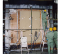
京都の伝統的軸組構法の木造土壁の火災安全性実験 * (H12)
